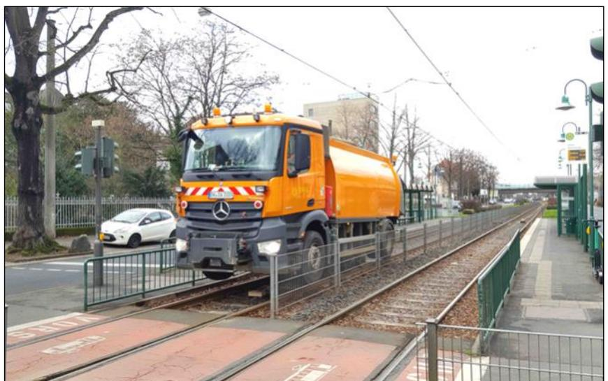
Das Weichen gereinigt werden müssen, klingt logisch. Die Weichenzungen müssen korrekt anliegen, damit die Bahnen nicht entgleisen. Und der Antrieb mit dem Gestänge darf nicht blockieren.
